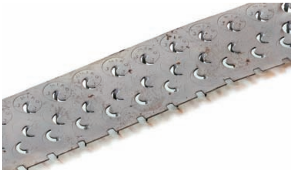
Trak s trirednim odrezom risalnih žebličkov iz prvega orodja, narejenega v obrti Nika Žumra v letih 1938/39. Orodje, ki predstavlja začetek orodjarstva v Železnikih, je bilo večkrat obnovljeno. Vzorec traku s fotografije je z začetka petdesetih let dvajsetega stoletja. / VIR: PETER POLAJNAR, FOTO: ANDREJ TARFILA
